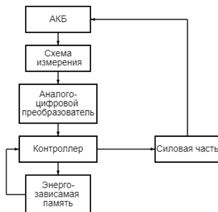
Рисунок 3. – Структурная схема силовой части и схемы измерения
