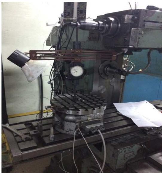
Рисунок 4. – Процесс калибровки оси Z
