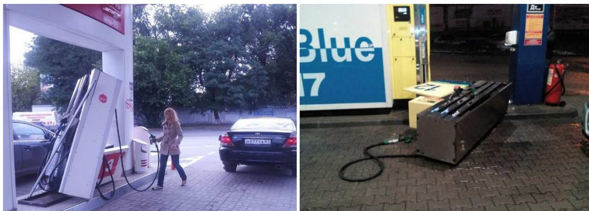
Рисунок 7. – ДТП, связанные с забывчивостью установить топливораздаточный кран в ТРК
