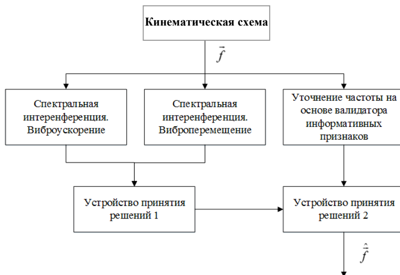
Рисунок 5. – Структурная схема алгоритма уточнения частоты
