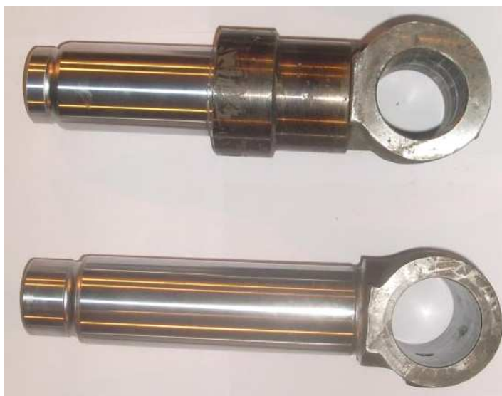
Рисунок 1. – Восстановленные штоки после обработки
